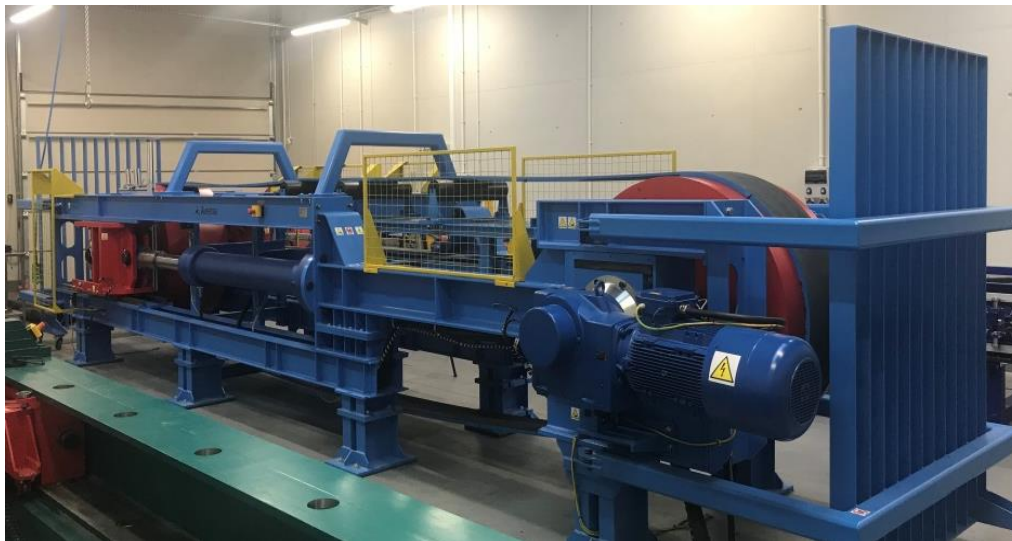
Stanowisko do badań dynamicznej wytrzymałości zmęczeniowej połączeń
