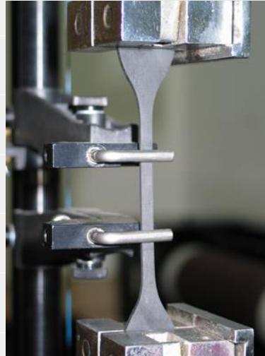
Wytrzymałość na rozciąganie i wydłużenia gumy okładkowej
