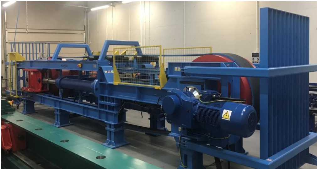
Stanowisko do badañ dynamicznej wytrzymałości zmęczeniowej połączyñ
